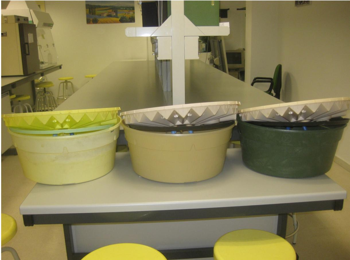
Figura 55.- Los tres tipos de waterboxx, donde se observa la segunda tapa. De izquierda a derecha tapa amarilla, BIO II, verde.
