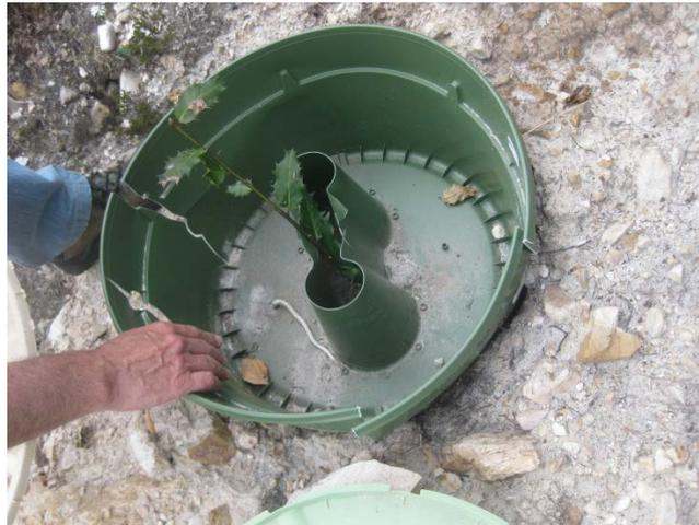
Figura 60.- Rotura del waterboxx por empujes del terreno.
