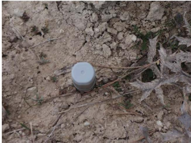
Figura 45.- Sensor térmico utilizado en el Programa LIFE09.
