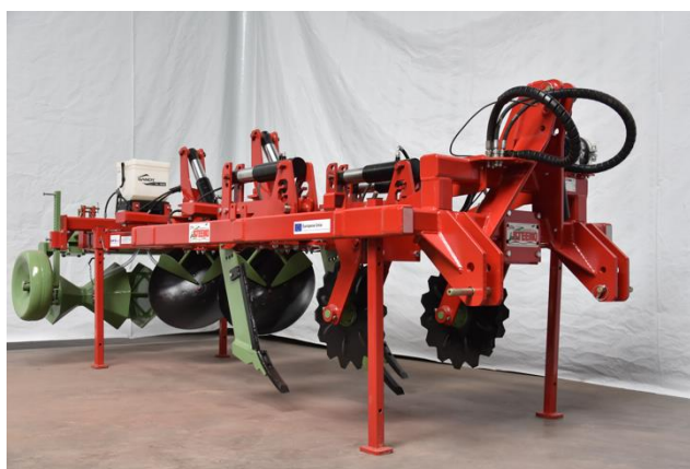
Groasis Terracedixx creëert 15.000 meter mini-terrassen per uur.
