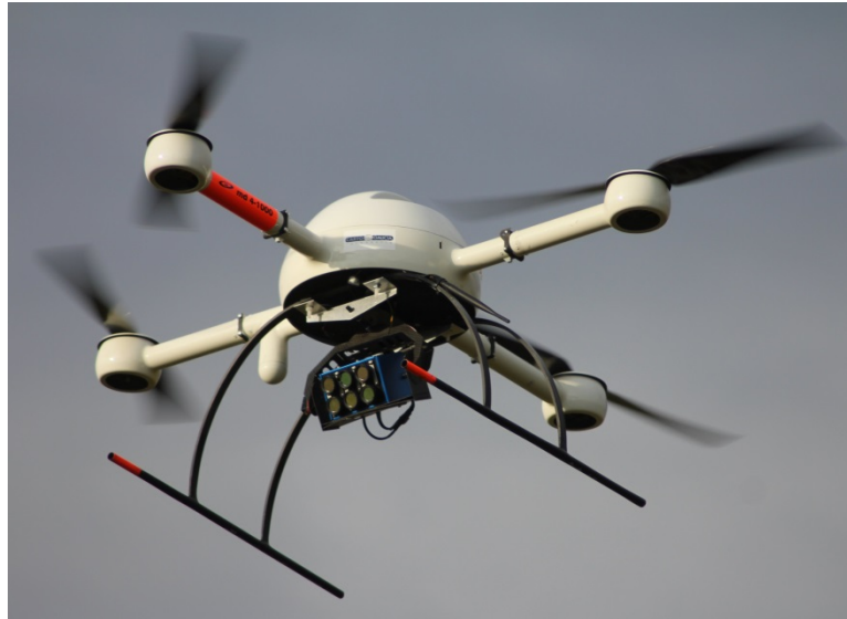
Figura 17.- Sensor multispectral Mini MCA-6 aerotransportado en un microdrone MD4-1000.
