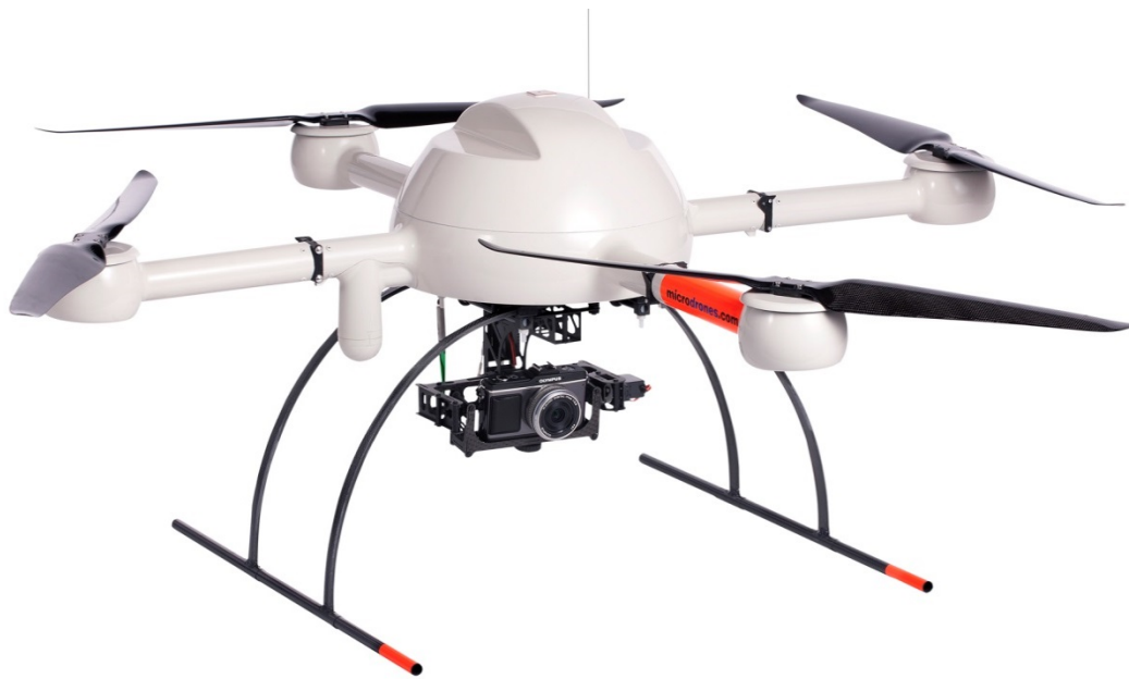
Figura 16.- Cámara fotográfica comercial (Olympus Pen) aerotransportada en un microdrone MD4-1000.
