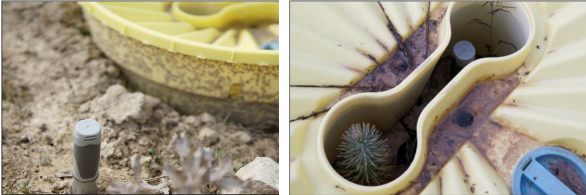
Figura 6.- Seguimiento de Temperaturas mediante sensores dentro y fuera del Waterboxx.
