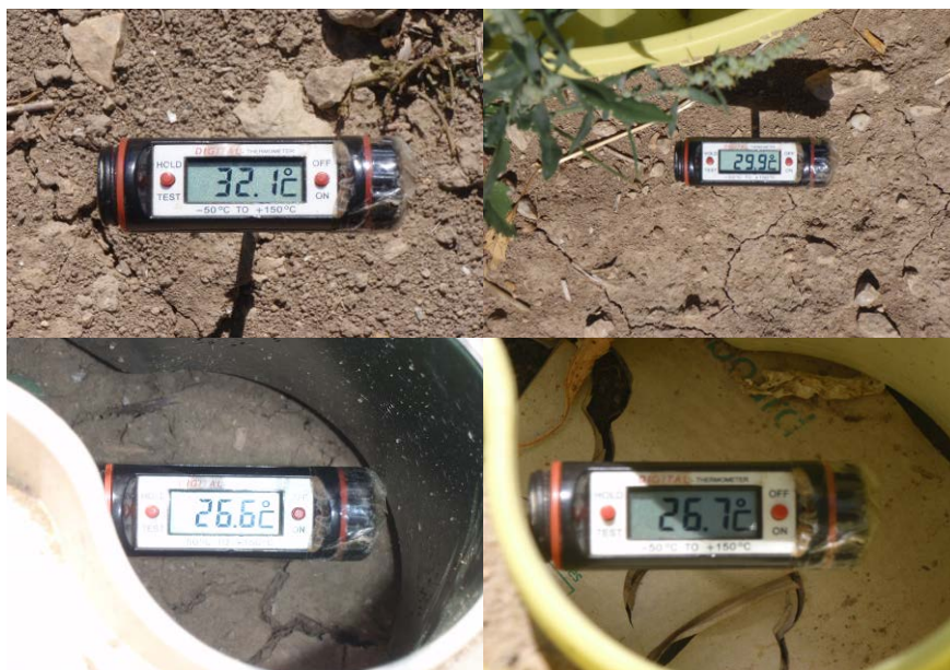
Figura 5.- Control de temperaturas dentro y fuera del waterboxx.
