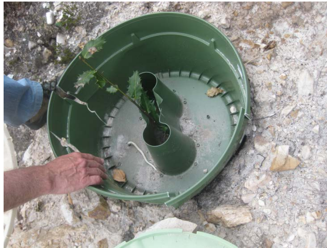
Figura 60.- Rotura del waterboxx por empujes del terreno.
